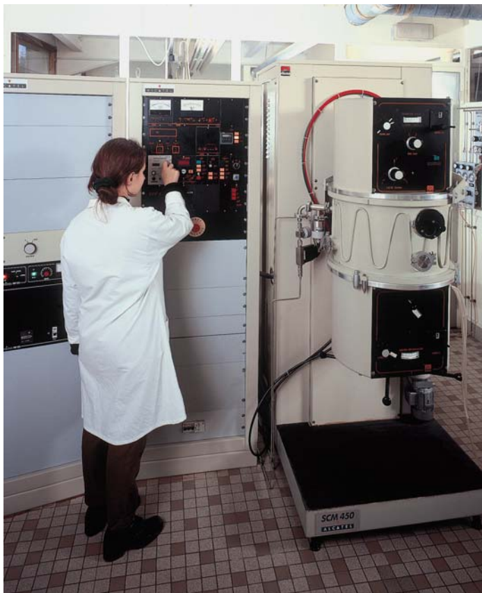
Machine de dépôt sous vide
